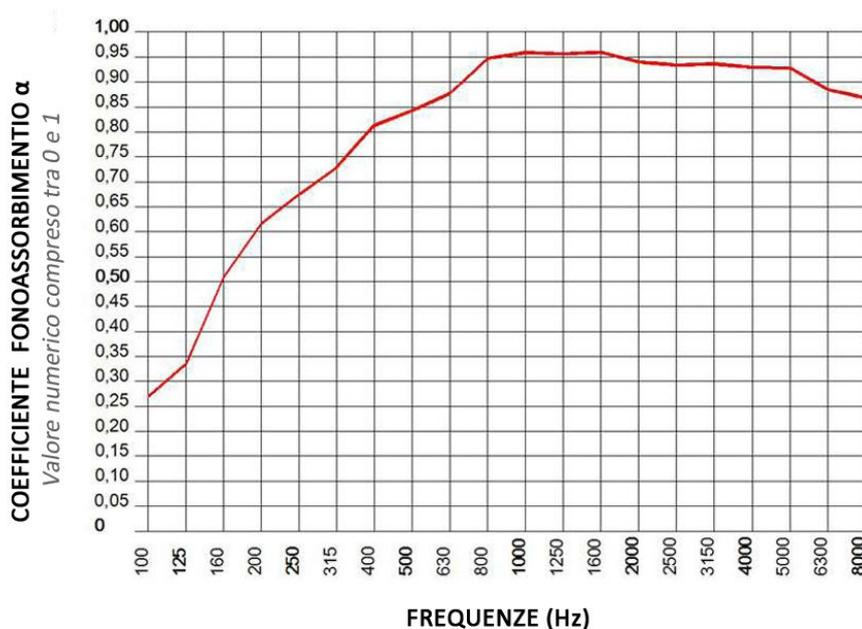
Prestazioni generali di fonoassorbimento e coefficienti alle singole frequenze eseguite in conformità con le disposizioni della norma UNI EN ISO 354:2003.
